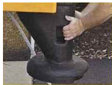
Spreddeplade og strøragt i Poly, kan let afmonteres uden værktøj
