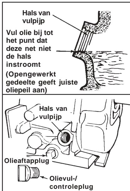
Afbeelding 5. Oliepeil bij CS motoren.
