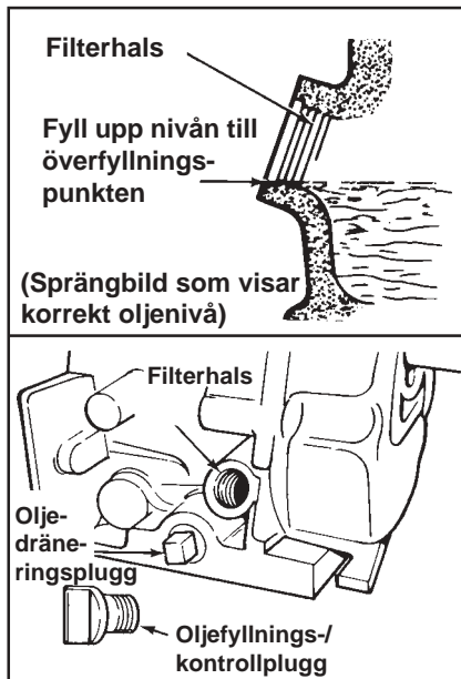
Figur 5. Oljenivå för motorer av typen CS.
