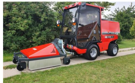
Varmluftanlæg for ukrudtsbekæmpelse genbruger op til 70% af sin egen energi. Arbejdsbredde 100 cm. Arbejdshastighed 1,5-4 km/t. Vægt 230 kg.
