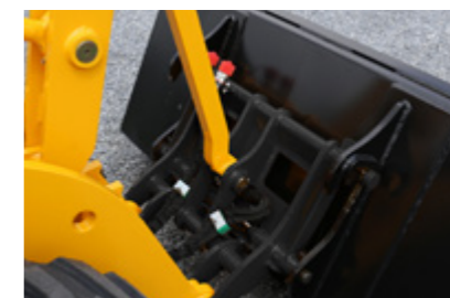
Schäffer SWH redskabsskifte med hydraulisk lås som standard. Alle redskaber kobles let og hurtigt.
