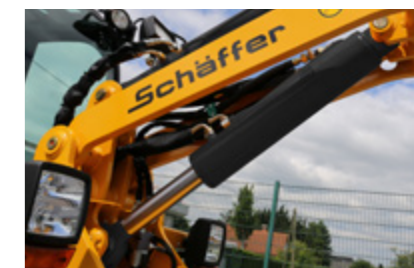
Løftecylinderen er specielt dimensioneret til de store løft og monteret med kugleled som beskyttelse mod vrid og slid.
