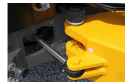
Det hydrauliske knæklæd med pendling er vedligeholdelsesfrit og med udvidet garanti.
