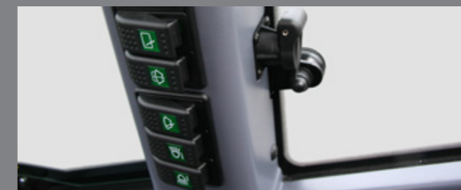
Samlet betjeningspanel og 12V udtag
