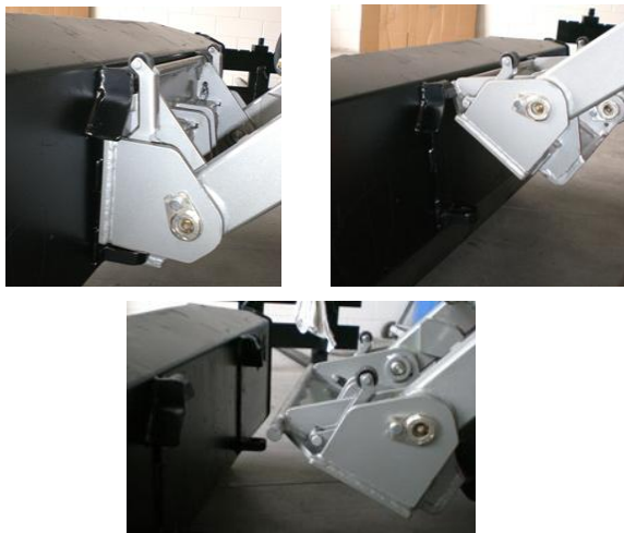
Fig. 17 Montering af redskab på hurtigskift
