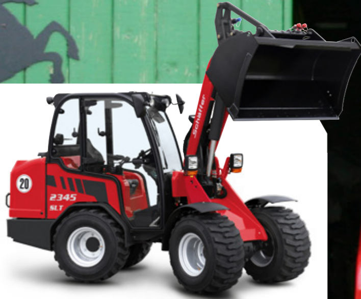
SLT maskinen fra 23 serien kan også fås med kabine men stadig kun med en totalhøjde på 1,95 m (afhængig af dækvalg)
