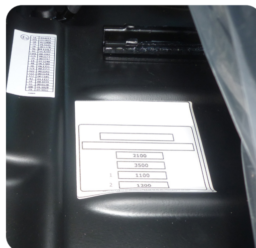
Producentplade i førerhuset under passagersæde
