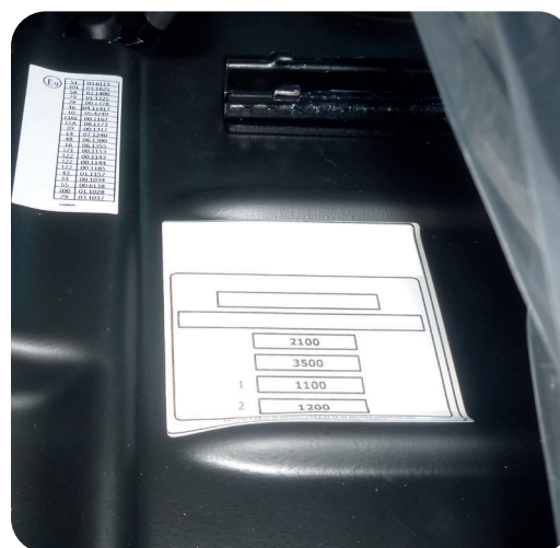
Producentplade under passagersædet inde i førerhuset
