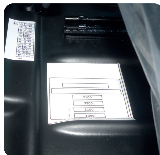
Producentplade i kabinen under passagersædet
