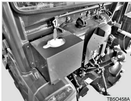
(1) Vaskemaskine Væske Tank
