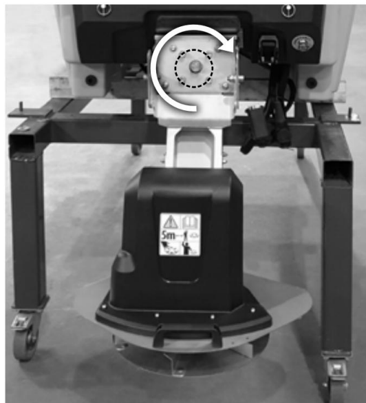
Brug en topnøgle til at rotere sneglen manuelt ved at dreje den med uret
