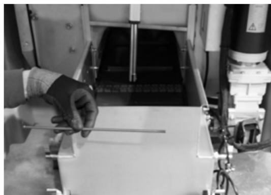
6. Fjern metalringen for enden af pinden, der holder samlingen sammen, og tag den ud gennem hullet.
