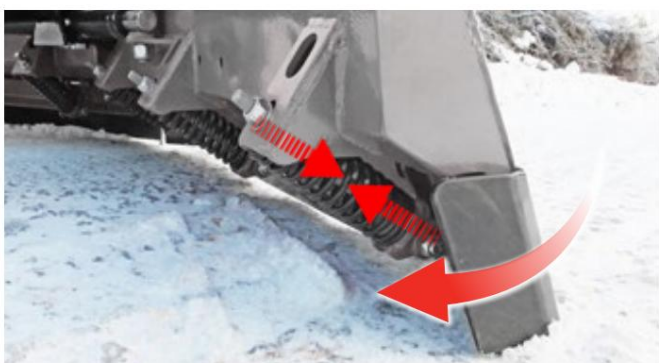
Skærende kant med udløserfjedre
