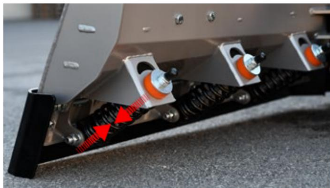
Skærende kant med udløserfjedre
