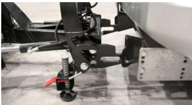
Hilltip hurtigskift - løft skohåndtaget for at fastgøre din plov til køretøjet
