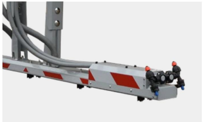
Dobbelte sprøjtedyser til afisning selv ved højere hastigheder
