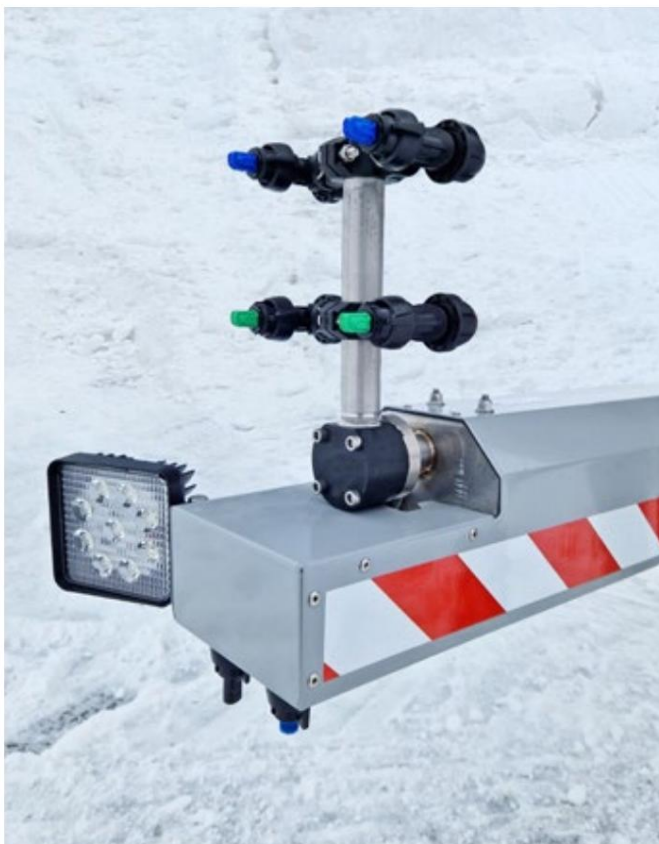
Sprøjtebjælke med dobbelt sprøjtedyse, sidedyser og LED-arbejdslys (valgfrit)
