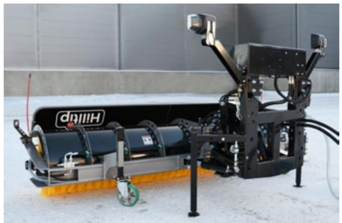
SweepAway™ 2600-3100 roterende kost med lystårn
