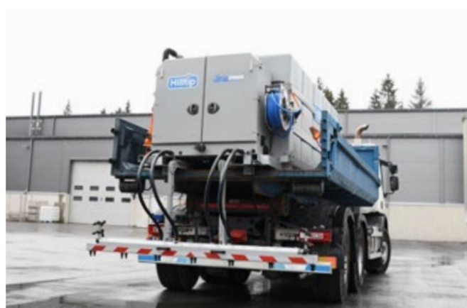
Vandingsarmen er udviklet til brug på lastbiler i kombination med SprayStriker™-sprøjten
