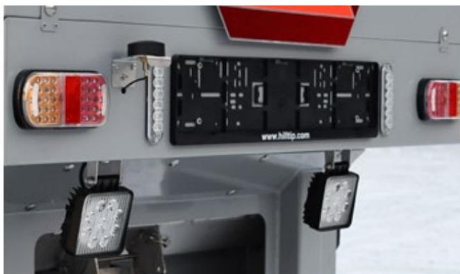
Belysnings sæt: 2 stk. LED-arbejdslygter, 2 stk. stroboskoplys og 2 stk. LED-stop-/bag-/bremselygter (valgfrit)
