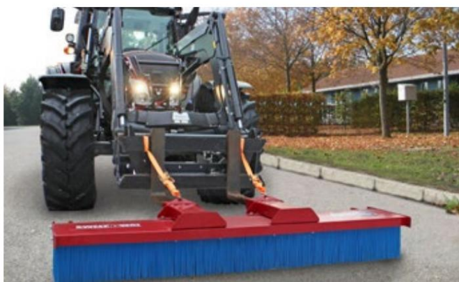
SweepAway™ mellemserie med 12 børsterækker
