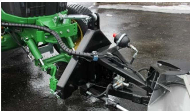
3-punktsophæng til traktorer
