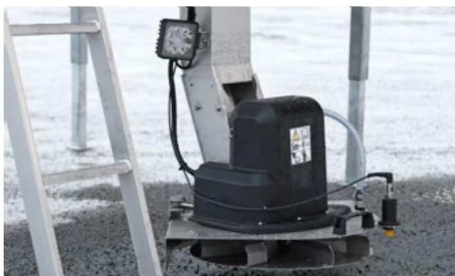
LED-arbejdslys og alarmsensor for materialeafslutning
