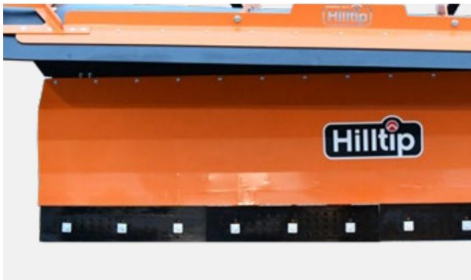
Skærekant i stål eller polyurethan med stålindlæg
