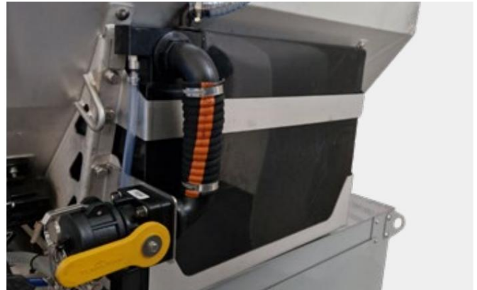
IceStriker™ 380 med forvædningsæt til saltvæske med indbyggede tanke i sprederkonstruktionen
