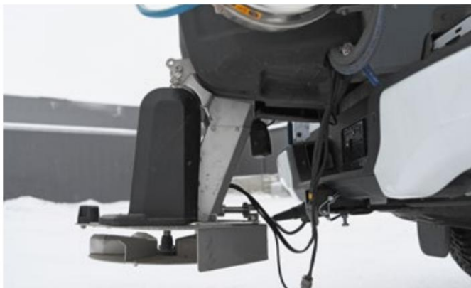
Rustfri ståloklappelig rende, designet til spredning af salt ved høj luftfugtighed
