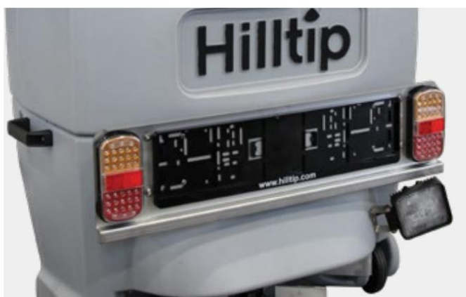
LED-baglygter, nummerpladesæt og LED-arbejdslygte
