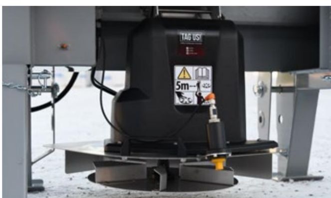
Alarmsensor for materialeafslutning på spinner
