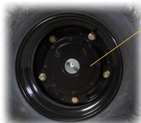
TRANSMISSION MOTORS PLANETARY REDUCERS
